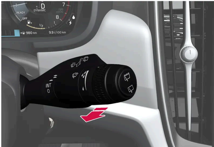
Fonction lave-glace, levier droit au volant
