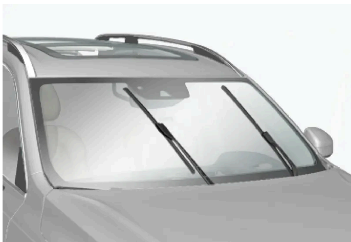
Balais d'essuie-glace en position d'entretien.
