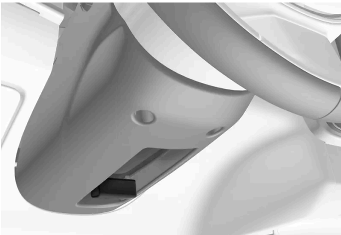
Levier de réglage du volant.
