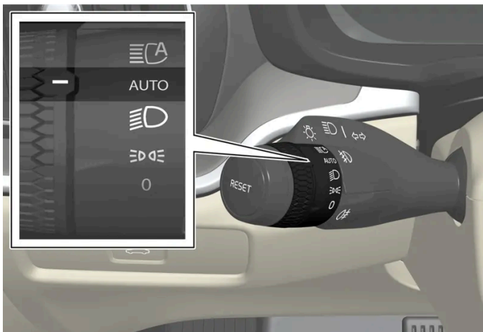
Molette du levier de volant en position AUTO.
