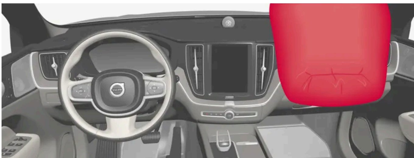
Coussin gonflable côté passager, siège avant.
