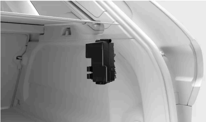
Emplacement de la boîte à fusibles
