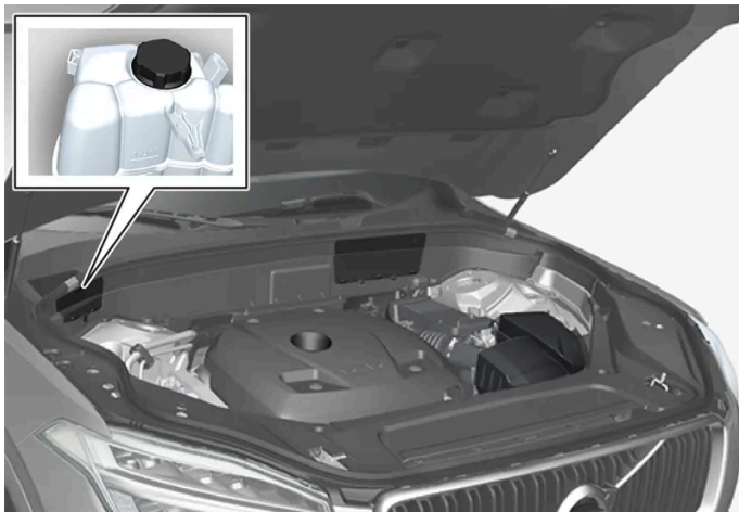
Vase d'expansion du système de refroidissement
