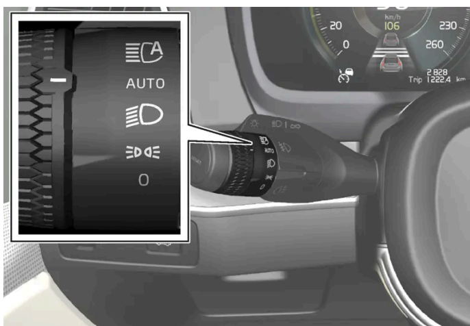
Molette du levier gauche au volant
