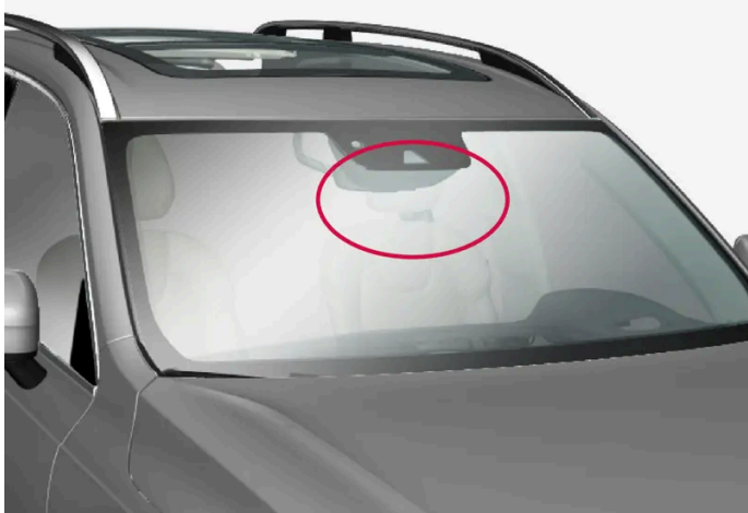
Position de l'unité radar avant
