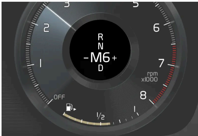
Indicateur de rapport sur l'écran conducteur 12 pouces, pour petit levier de vitesse*.
