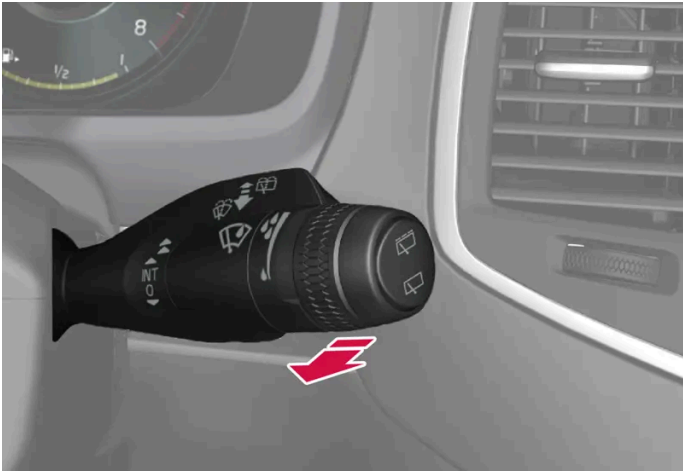
Fonction lave-glace, levier droit au volant
