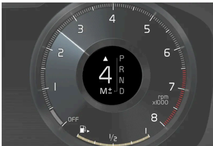
Indicateur de rapport sur l'écran conducteur 12 pouces, pour gros levier de vitesse*.
