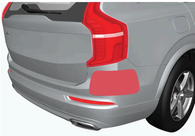
Position des unités radar arrière
