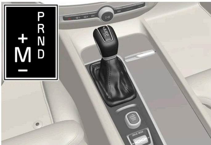
Vue d'ensemble du gros levier de vitesses avec grille de passage des rapports sur l'écran conducteur.
