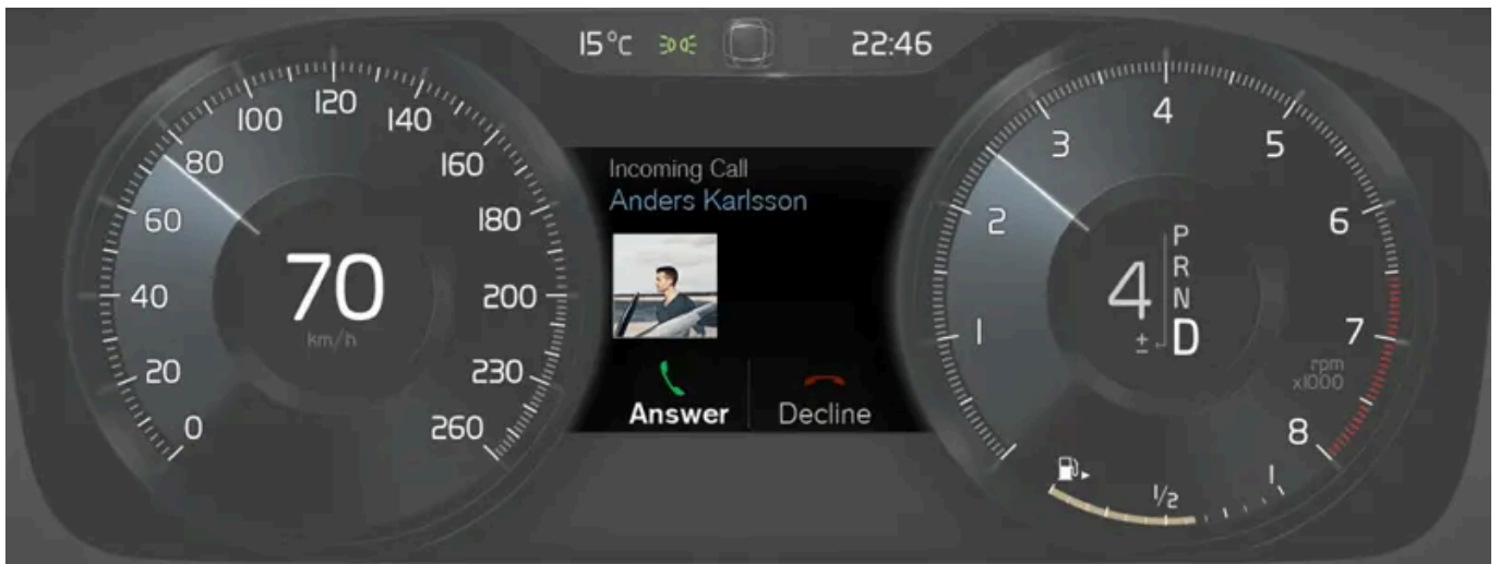
Exemple de message sur l'écran conducteur. L'illustration est schématique, les détails peuvent varier selon le modèle de la voiture.
