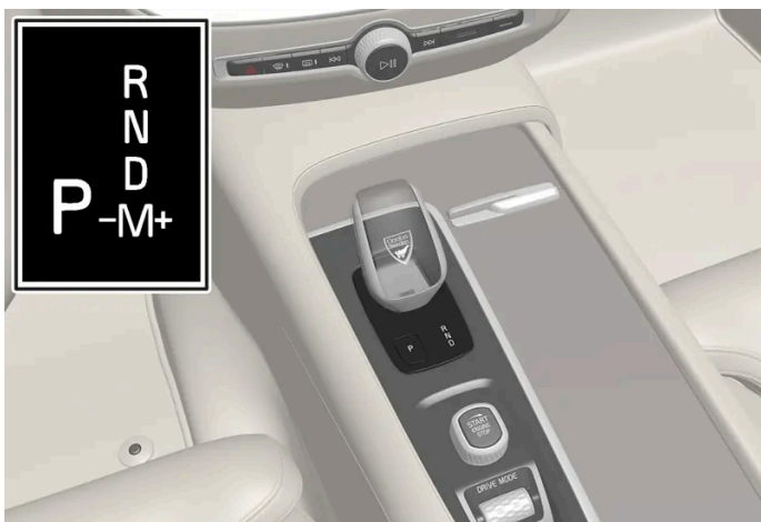
Vue d'ensemble du petit levier de vitesses avec grille de positions sur l'écran conducteur.
