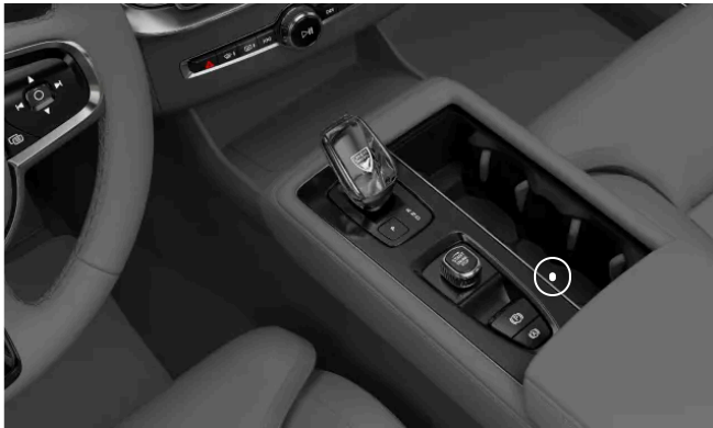
Emplacement du lecteur de sauvegarde à l'intérieur du porte-gobelet de la console de tunnel
