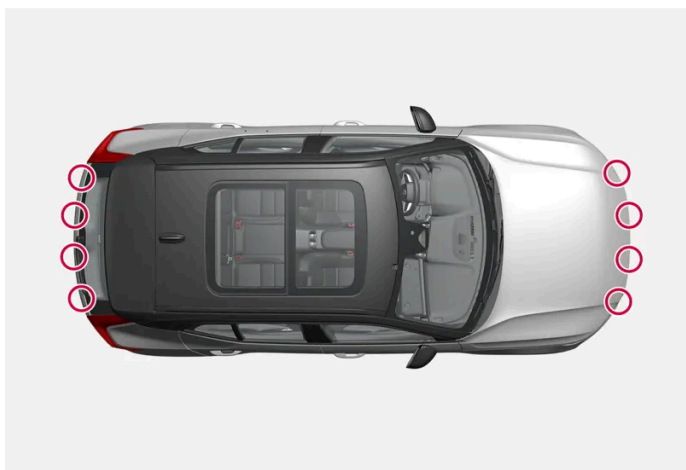
Θέση των αισθητήρων στάθμευσης περιμετρικά του αυτοκινήτου
