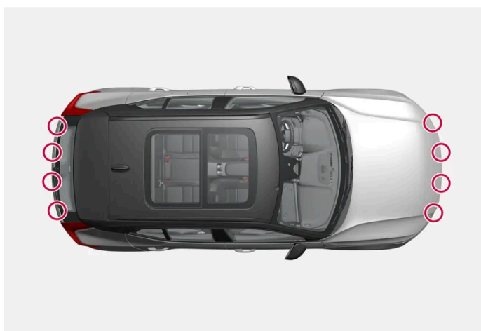
Θέση των αισθητήρων στάθμευσης περιμετρικά του αυτοκινήτου
