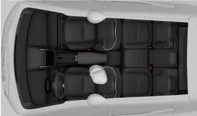
Αερόσακοι πλευρικής σύγκρουσης για οδηγό και συνοδηγό.
