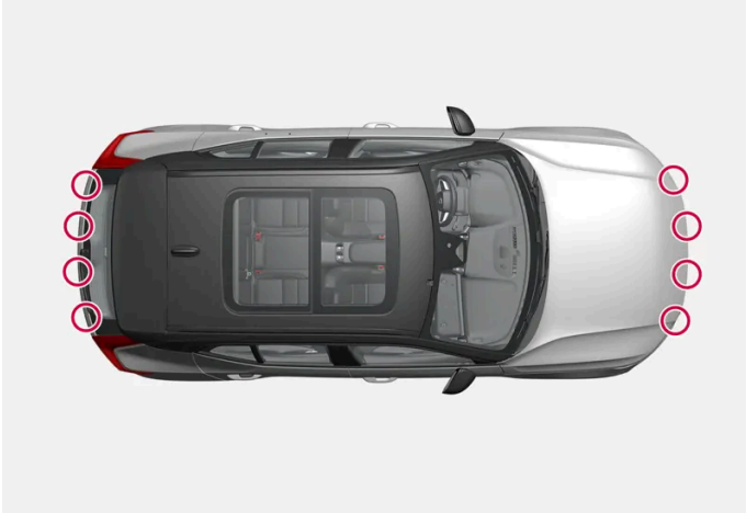
Θέση των αισθητήρων στάθμευσης περιμετρικά του αυτοκινήτου
