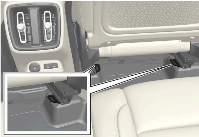
Θέσεις σημείων στερέωσης στο πίσω κάθισμα.
