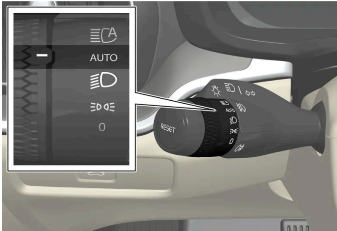
Περιστρεφόμενος δακτύλιος του μοχλοδιακόπτη στη θέση ΑΥΤΟ .
