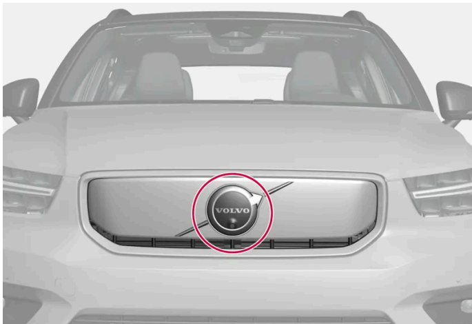
Θέσης της μπροστινής μονάδας ραντάρ
