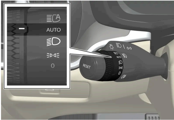
Περιστρεφόμενος δακτύλιος του μοχλοδιακόπτη στη θέση AUTO.
