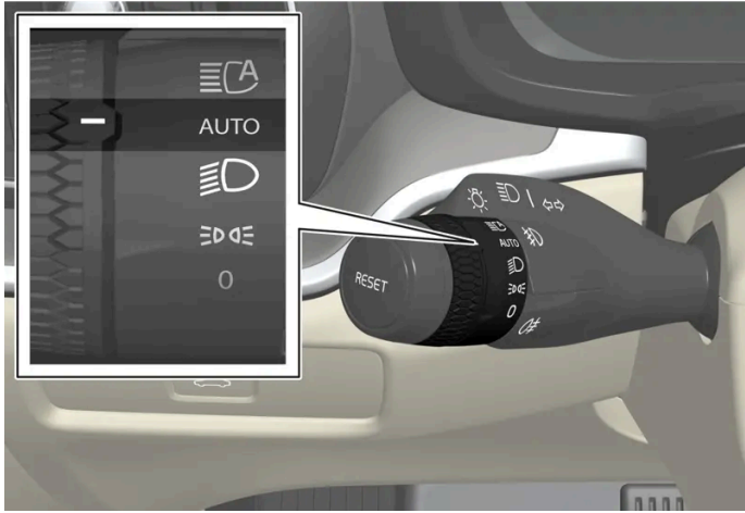
Περιστρεφόμενος δακτύλιος του μοχλοδιακόπτη στη θέση ΑΥΤΟ .
