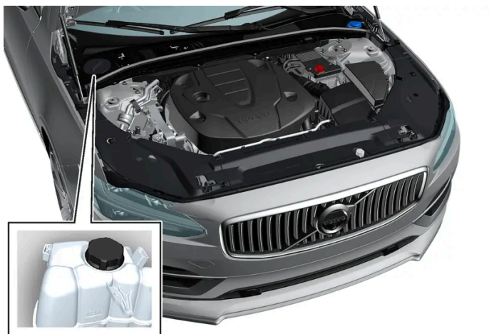
Δοχείο διαστολής ψυκτικού, αριστεροτίμονο αυτοκίνητο.
