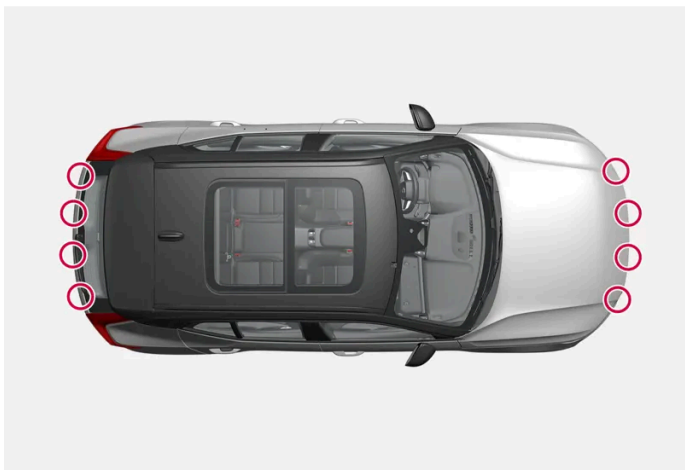
Θέση των αισθητήρων στάθμευσης περιμετρικά του αυτοκινήτου
