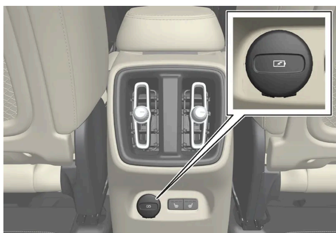
Θύρες USB* (τύπου C) στο πίσω μέρος της επιμήκους κονσόλας για τη φόρτιση τηλεφώνων και tablet [1] , για παράδειγμα.
