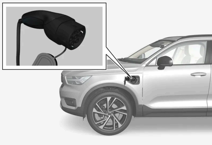
Λαβή καλωδίου φόρτισης και υποδοχή φόρτισης.
