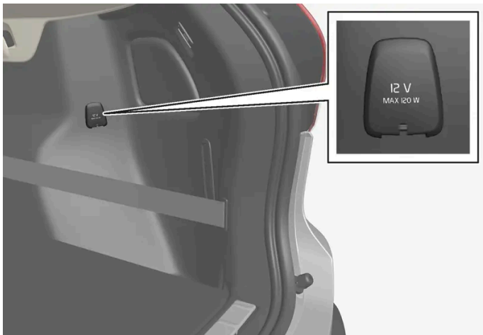
Ρευματοδότης 12 V στον χώρο αποσκευών*.
