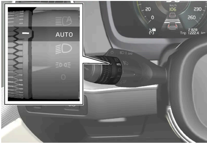
Περιστρεφόμενος δακτύλιος του μοχλοδιακόπτη στη θέση \text{AUTO} .
