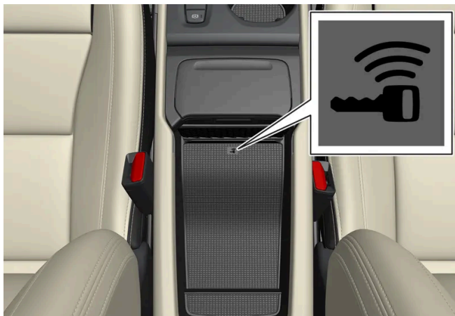
Θέση της εφεδρικής μονάδας ανάγνωσης στον αποθηκευτικό χώρο.
