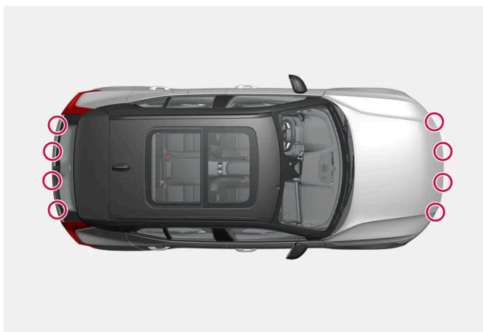
Θέση των αισθητήρων στάθμευσης περιμετρικά του αυτοκινήτου
