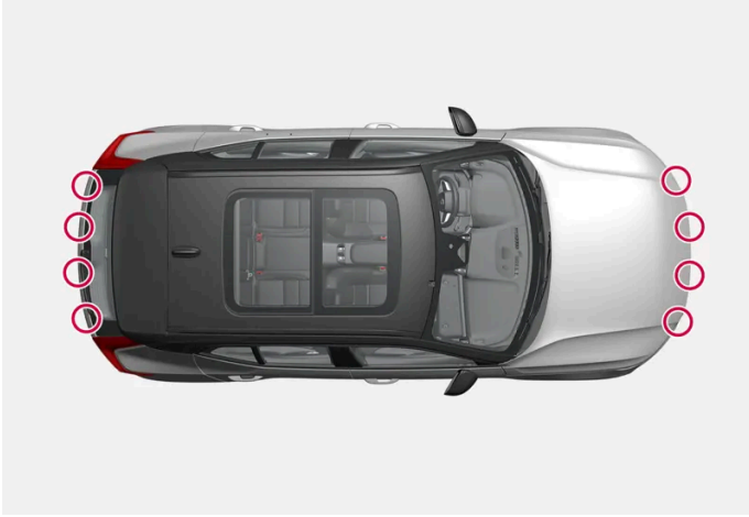
Θέση των αισθητήρων στάθμευσης περιμετρικά του αυτοκινήτου
