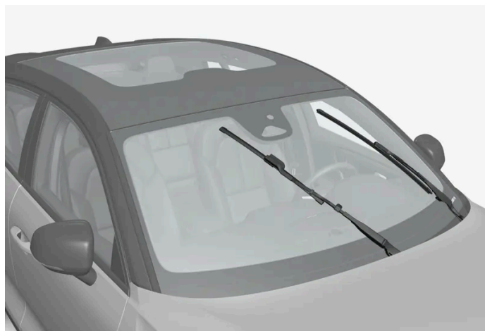
Spazzole tergicristallo in posizione di assistenza.
