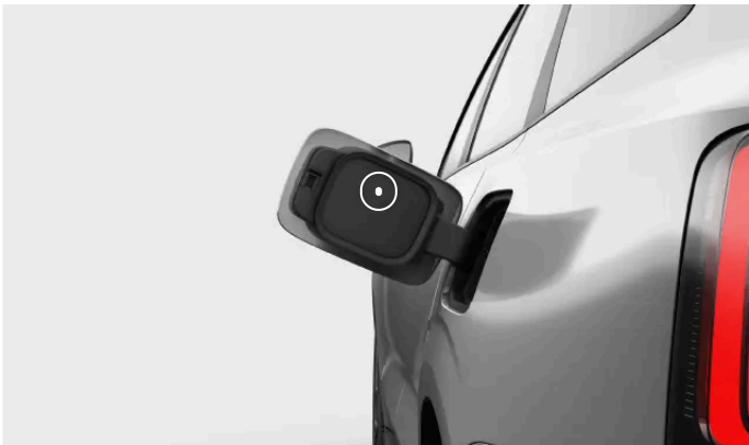
L'etichetta identificativa si trova all'interno dello sportello di carica.
