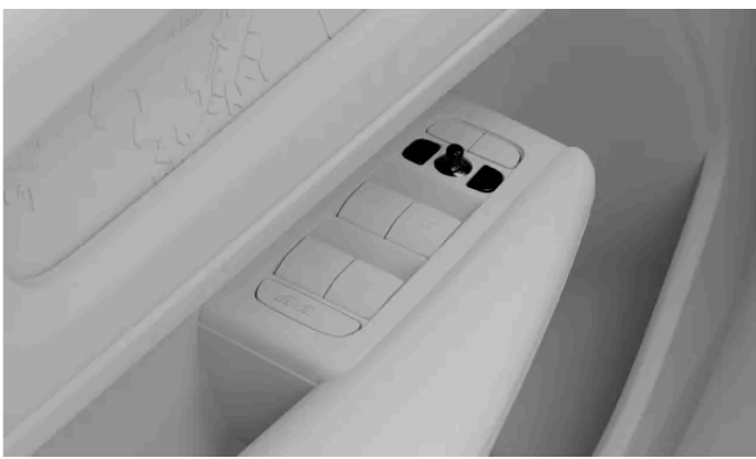
Comandi per la regolazione degli specchietti laterali
