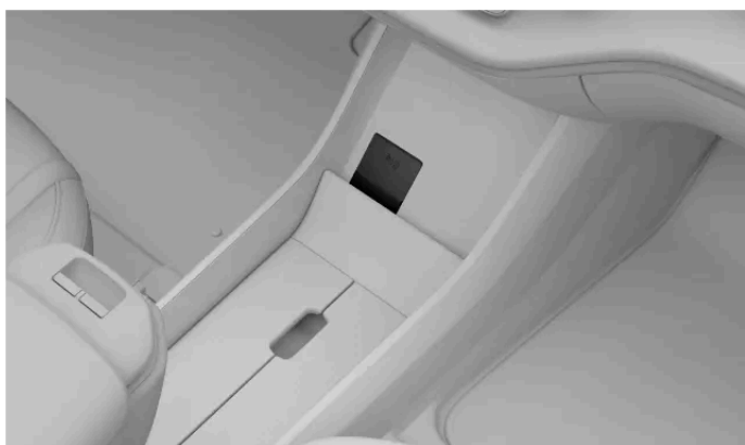
Il lettore tra i sedili anteriori funziona anche da caricabatteria wireless.
