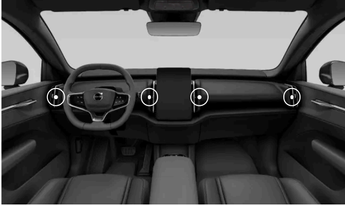
Posizione delle bocchette di ventilazione regolabili.
