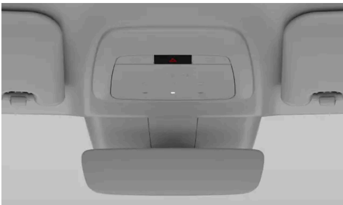
Posizione del pulsante delle luci d'emergenza nella consolle superiore
