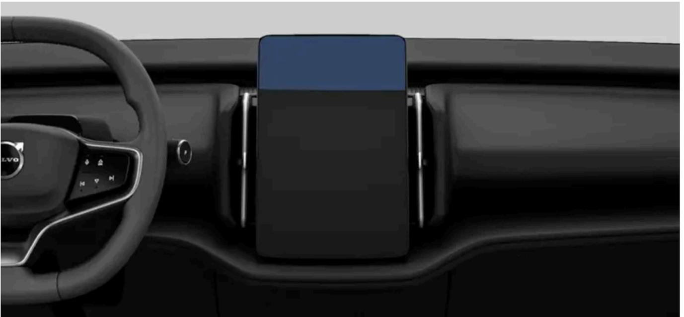
L'area delle informazioni per il conducente non è sensibile al tocco, quindi non puoi interagire toccando la superficie del display. Puoi interagire con l'area delle informazioni per il conducente usando i pulsanti sul volante.
