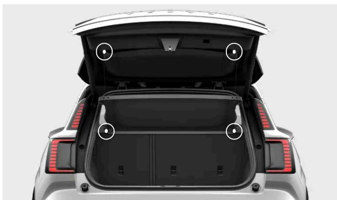
Ci sono due punti di fissaggio sul piano portaoggetti e due sul portellone del bagagliaio. Quando il piano portaoggetti è montato, i cordoni sono fissati tra gli appositi punti sul piano portaoggetti e il bagagliaio.
