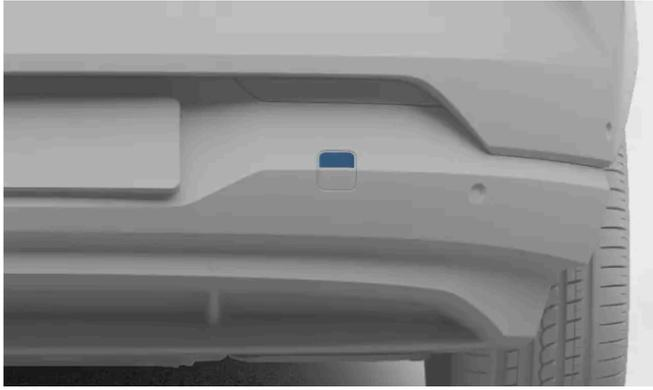
Coperchio di fissaggio dell'occhiello di traino posteriore.
