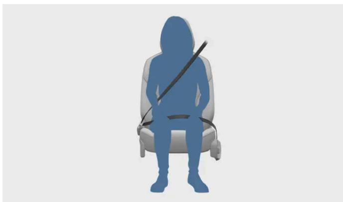
In determinate condizioni, la cintura di sicurezza si blocca da sola e agisce come un dispositivo di sicurezza. Ad esempio quando viene tirata con forza e in modo improvviso, se l'auto viene guidata in modo aggressivo o se si trova su una forte pendenza.
