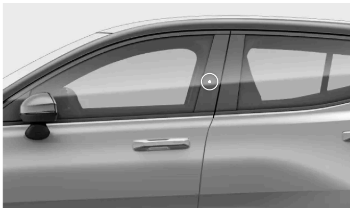
Posizione di lettura delle chiavi sul montante della portiera del conducente
