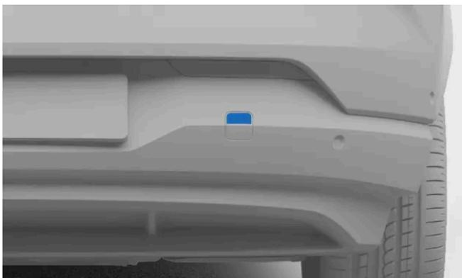
Coperchio di fissaggio dell'occhiello di traino posteriore.
