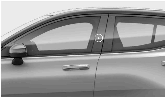
Posizione di lettura delle chiavi sul montante della portiera del conducente
