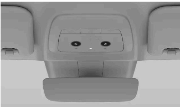
La console superiore che integra le luci di lettura del sedile anteriore
