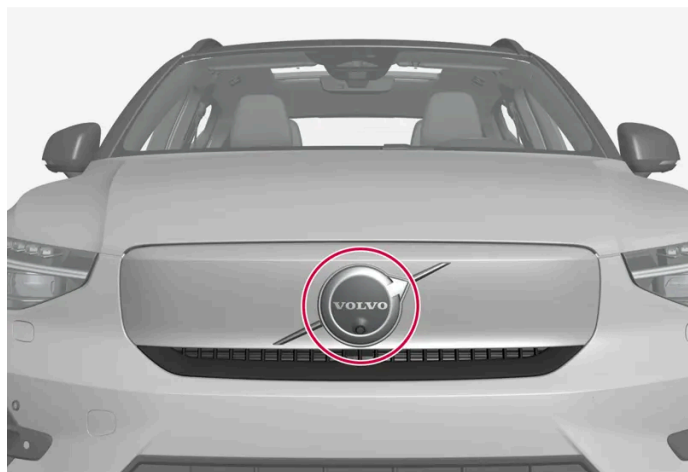
Posizione dell'unità radar anteriore
