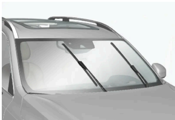
Spazzole tergicristallo in posizione di assistenza.
