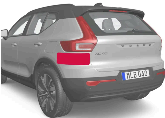
Posizione delle unità radar posteriori
