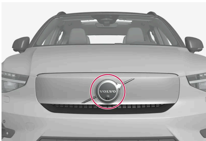
Posizione dell'unità radar anteriore
