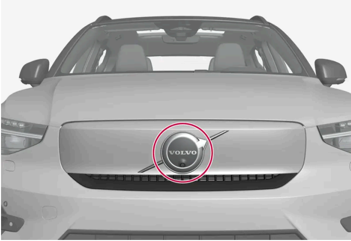
Posizione dell'unità radar anteriore
