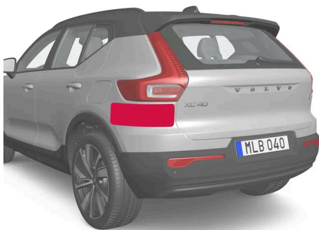
Posizione delle unità radar posteriori
