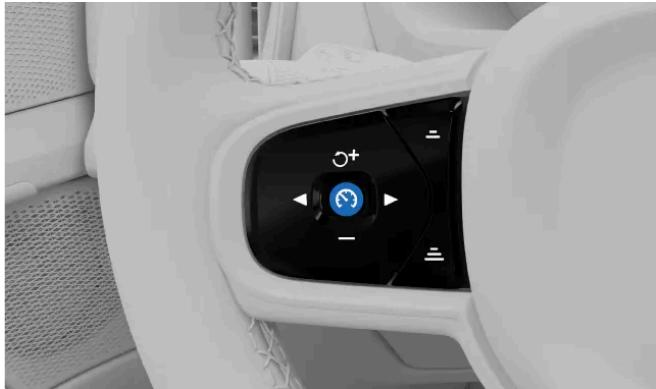
Quando puoi farlo in modo sicuro, premi il pulsante dell'Adaptive Cruise Control
