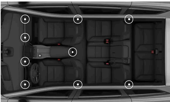
Posizione delle bocchette di ventilazione regolabili
