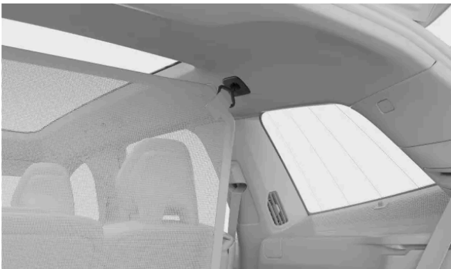
Installazione dietro i sedili della seconda fila
