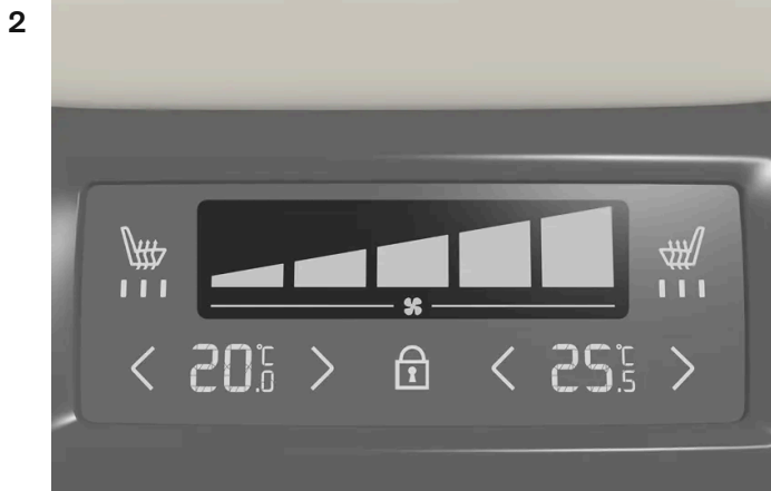
Comandi della ventola sul pannello del climatizzatore sul retro del tunnel.
