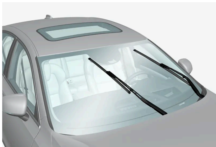
Spazzole tergicristallo in posizione di assistenza.
