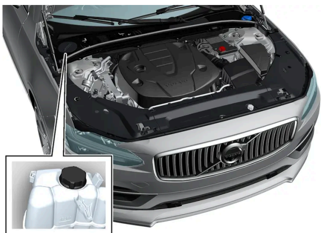
Serbatoio di espansione dell'impianto di raffreddamento, automobile con guida a sinistra.
