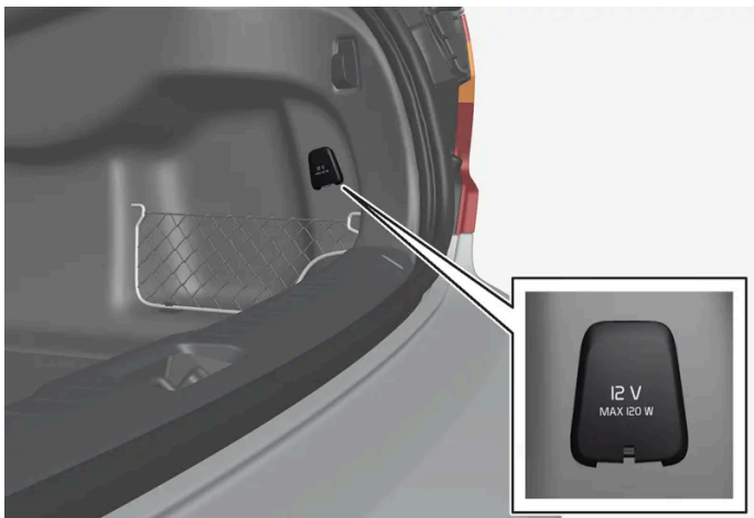
Presenza elettrica da 12 V nel bagagliaio*.
