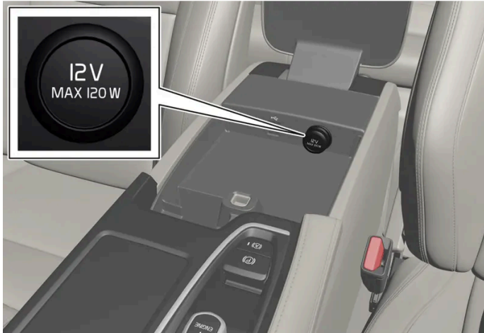
Presenza elettrica da 12 V nel tunnel, sedile anteriore.
