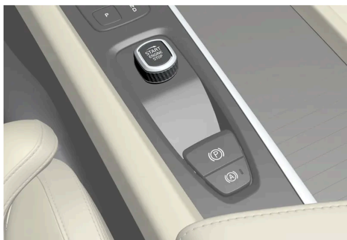
Interruttore di avviamento nel tunnel.
