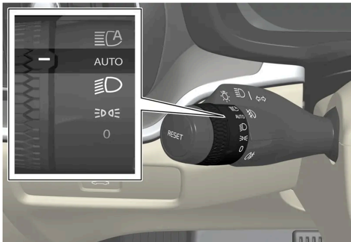
Rotella della leva al volante in posizione AUTO .
