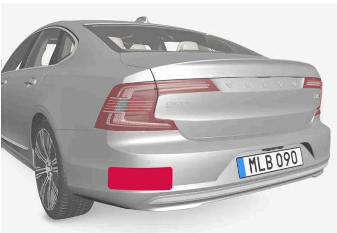
Posizione delle unità radar posteriori
