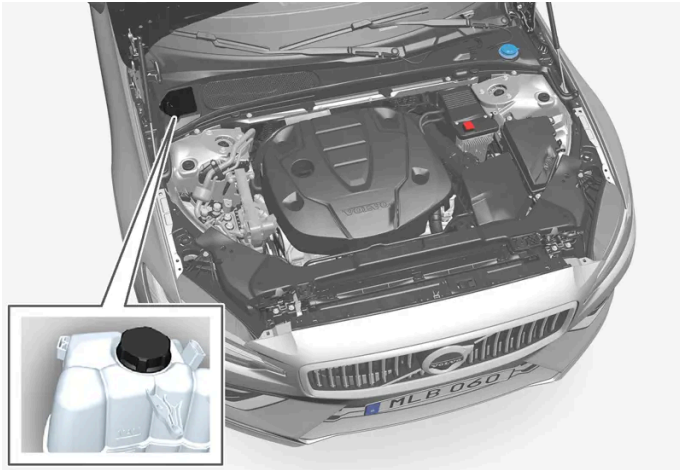
Serbatoio di espansione dell'impianto di raffreddamento
