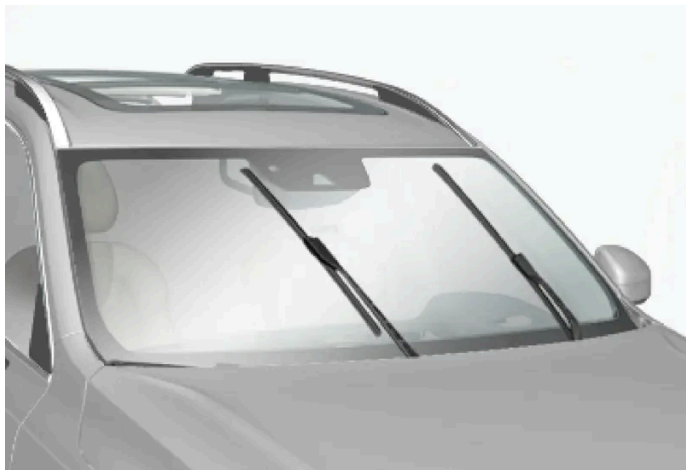
Spazzole tergicristallo in posizione di assistenza.
