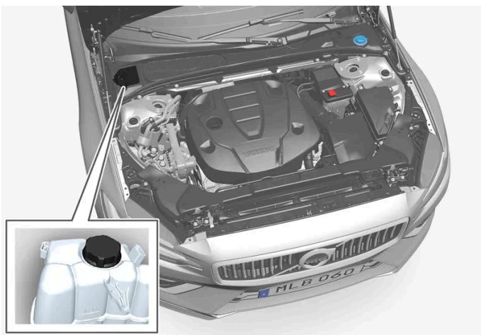
Serbatoio di espansione dell'impianto di raffreddamento
