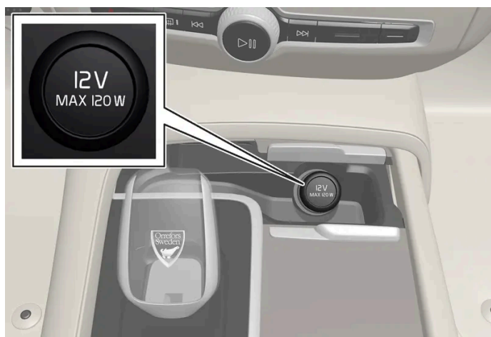
Presenza elettrica anteriore nel tunnel per le automobili con caricabatteria wireless per telefono*.
