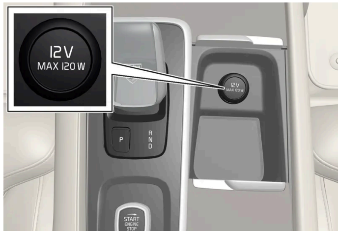
Presenza elettrica anteriore nel tunnel per le automobili senza caricabatteria wireless per telefono*.
