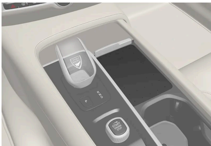
Caricatore wireless nel tunnel.
