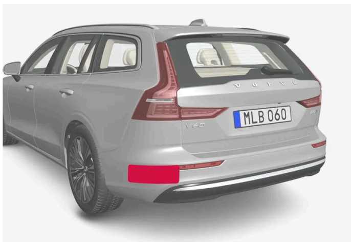
Posizione delle unità radar posteriori
