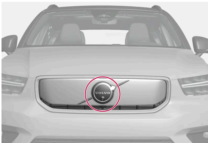
Posizione dell'unità radar anteriore
