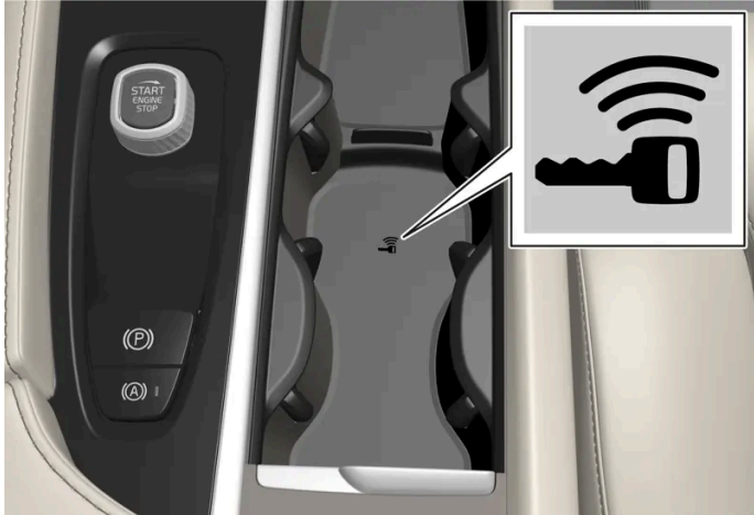
Posizione del lettore di riserva nella consolle del tunnel.
