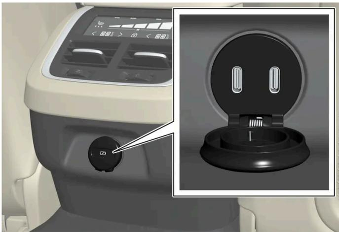
Porte USB (tipo C) nel tunnel, sedile posteriore.
