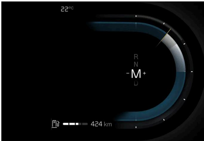
Con la posizione M è possibile cambiare marcia manualmente. Rilasciando il pedale dell'acceleratore, si attiva il freno motore.
