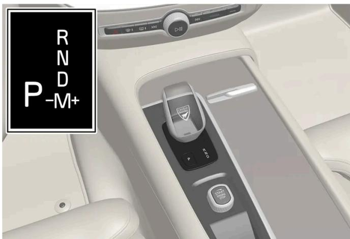
Panoramica della leva selettoria e schema di cambio sul display del conducente.
