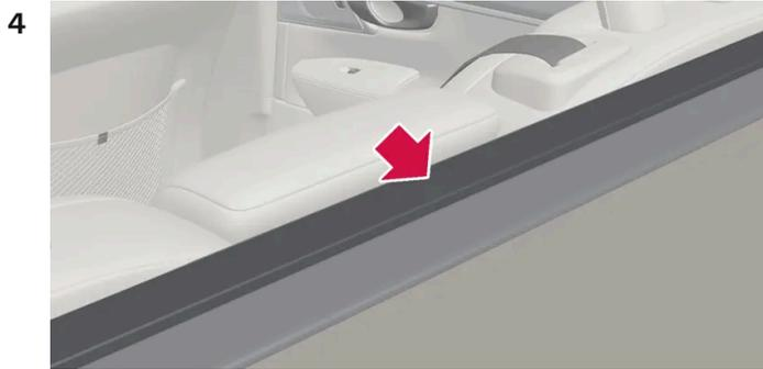
Ripiegare in avanti la piastra protettiva anteriore del copribagagliaio per eliminare lo spazio fra copribagagliaio e schienale posteriore.
