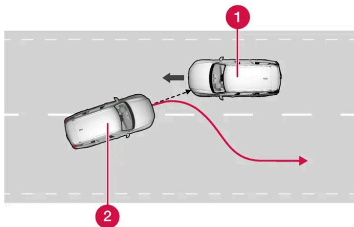
La funzione può assistere il conducente riportando l'automobile sulla propria corsia di marcia.
