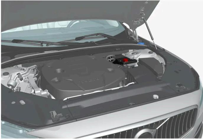
La batteria ausiliaria da 12 V si trova nel vano motore.
