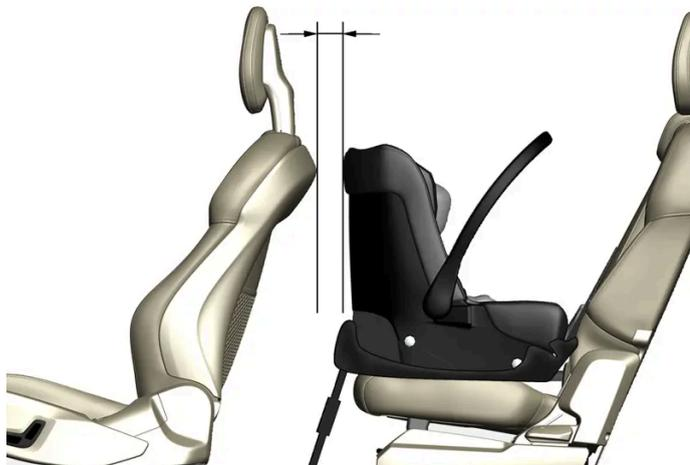
Per il montaggio di protezioni per neonati nel sedile posteriore, Volvo raccomanda di mantenere una distanza di almeno 50 mm (2 pollici) dalla parte anteriore della protezione per neonati alla parte posteriore del sedile davanti.
