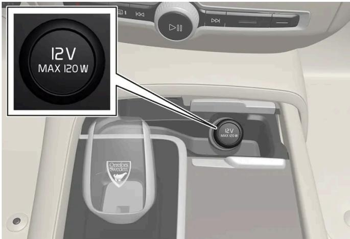
Preso elettrica anteriore nel tunnel per le automobili con caricabatteria wireless per telefono\*.
