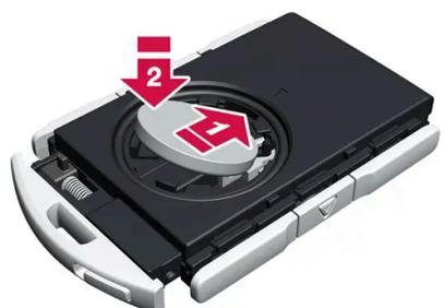
Inserire una nuova batteria con il lato + verso l'alto. Evitare di toccare con le dita i contatti della batteria della chiave.
