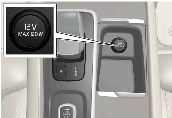
Preso elettrica anteriore nel tunnel per le automobili senza caricabatteria wireless per telefono\*.
