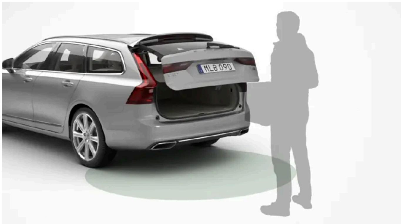
Se l'automobile è dotata di bloccaggio e sbloccaggio senza chiave\*, è possibile sbloccare il portellone con un movimento del piede.
