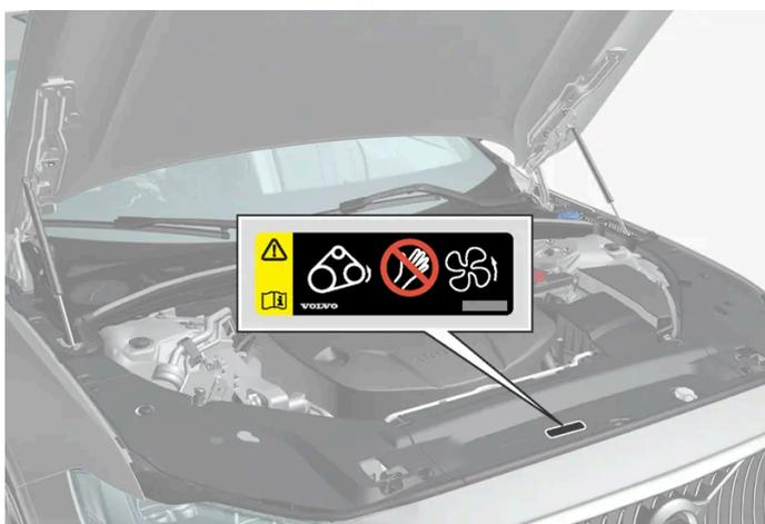
Posizione dell'etichetta di avvertimento per il vano motore. Il vano motore può differire in base al modello e al tipo di motore.
