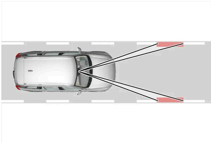
Driver Alert rileva la posizione dell'automobile nella corsia di marcia.
