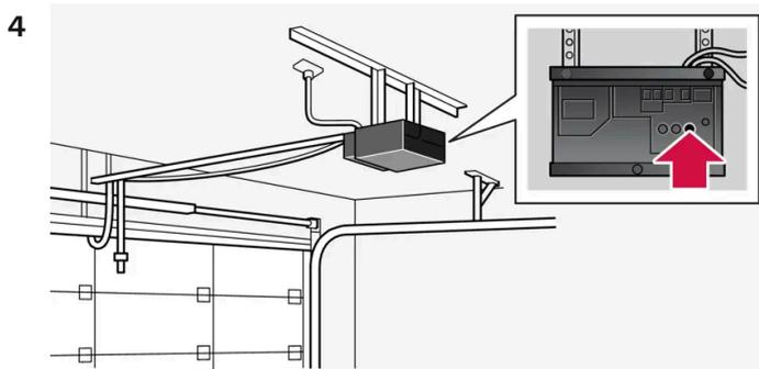
Localizzare il pulsante di apprendimento<sup>[2]</sup> del ricevitore, ad esempio del portone del garage. Solitamente si trova accanto all'attacco dell'antenna sul ricevitore.
