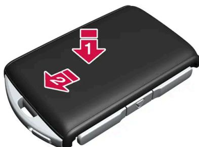
Rimontare il guscio posteriore in ordine inverso rispetto a come è stato rimosso. Il guscio posteriore è privo di logo. Fissare a pressione il guscio finché non sia prodotto un clic e poi spingerlo per gli ultimi millimetri nella posizione originaria.
