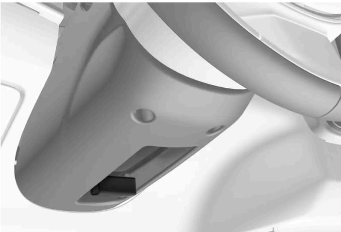
Leva per la regolazione del volante.
