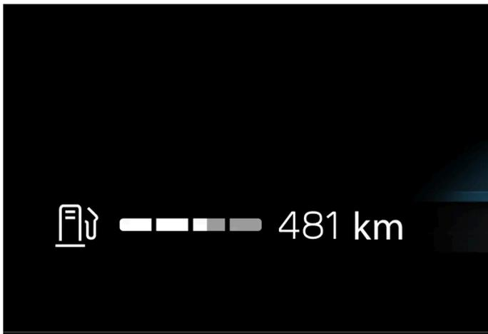
L'area bianca nell'indicatore del carburante mostra la quantità di carburante nel serbatoio.
