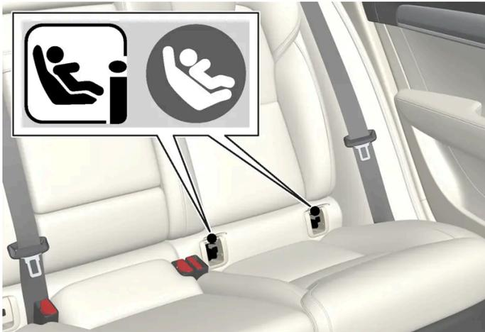
La posizione dei punti di fissaggio per il sedile posteriore è indicata da simboli<sup>[1]</sup> sui coperchi che nascondono i punti di fissaggio.
