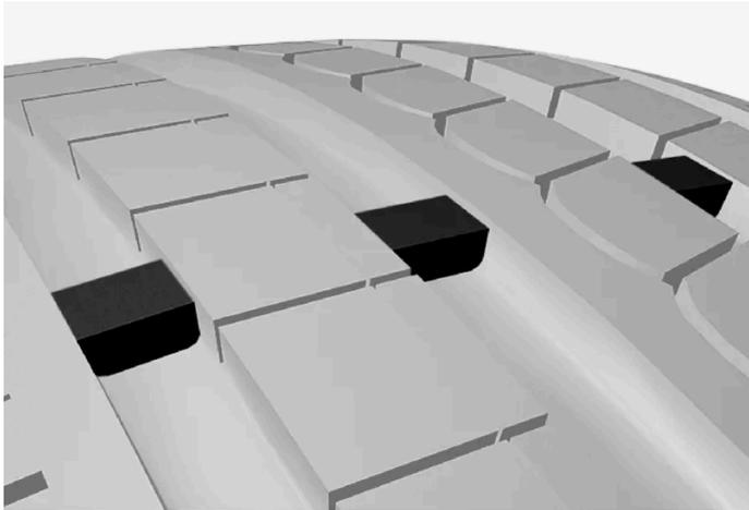
L'indicatore di usura è rappresentato da piccole bande trasversali rialzate sui solchi longitudinali del pneumatico. La sigla TWI (Tread Wear Indicator) è stampata sul lato del pneumatico. Quando il pneumatico è consumato a tal punto che rimangono solo 1,6 mm (1/16") di battistrada, queste bande sono chiaramente visibili. In tal caso, sostituire i pneumatici al più presto. Ricordare che un pneumatico con un battistrada così sottile ha un'aderenza molto scarsa in caso di pioggia o neve.
