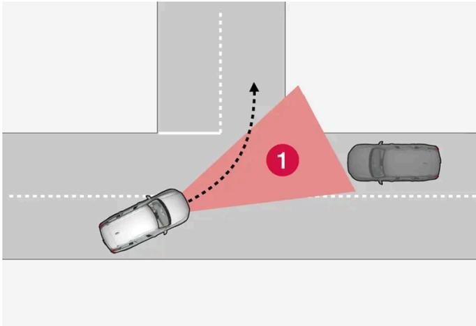
**1** Settore in cui la funzione è in grado di rilevare un veicolo che procede in direzione trasversale opposta.
