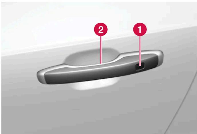
**1** Rientranza sensibile per il bloccaggio
