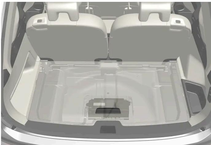
Le auto di tipo Mild Hybrid sono dotate di una batteria ausiliaria da 48 V ubicata sotto il vano di carico. La batteria e la scatola intorno possono essere manipolate solo da riparatori autorizzati.
