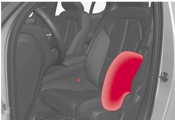
Gli airbag laterali esterni sono montati sui lati esterni degli schienali dei sedili anteriori ed assistono a proteggere il conducente ed il passeggero del sedile anteriore.
