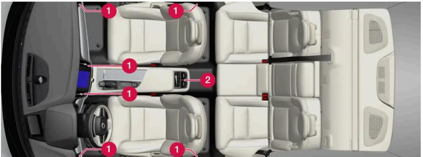
Posizione delle bocchette di ventilazione regolabili nell'abitacolo.
