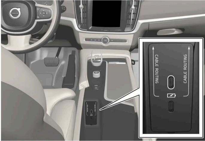
Porte USB per il caricamento delle unità.
