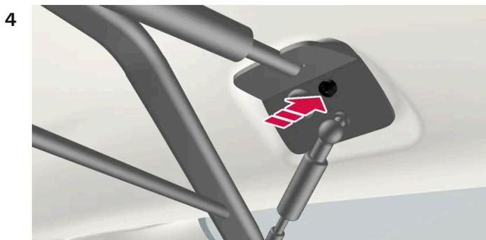
Installare la vite in dotazione e serrarla con la chiave a brugola da 6 mm in dotazione. Ripetere sul lato opposto. Coppia di serraggio raccomandata: 20 Nm (15 ft. lbs).
