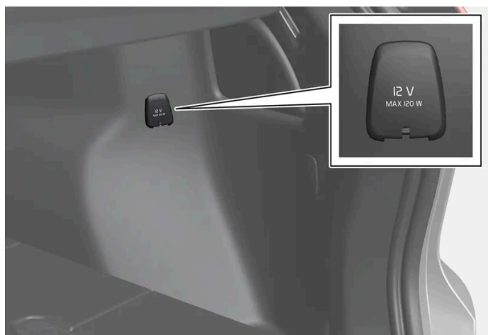
Presa elettrica da 12 V nel vano di carico*. [1]
