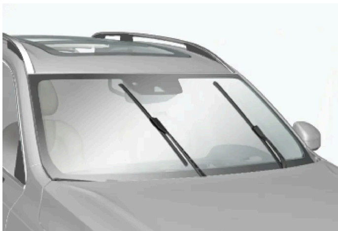
Spazzole tergicristallo in posizione di assistenza.
