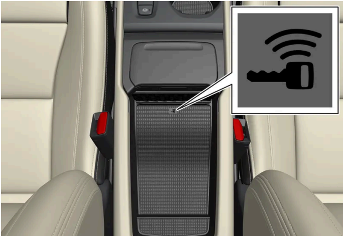
Posizione del lettore di riserva nella consolle del tunnel.
