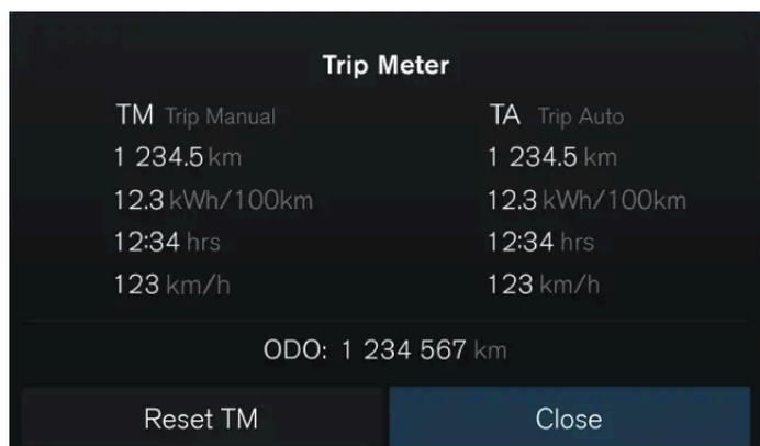
La tua auto è provvista di un contachilometri parziale e di un contachilometri. Il contachilometri parziale può mostrarti informazioni sulla distanza percorsa e sul tempo di guida della tua auto, oltre al consumo medio e alla velocità di guida.
