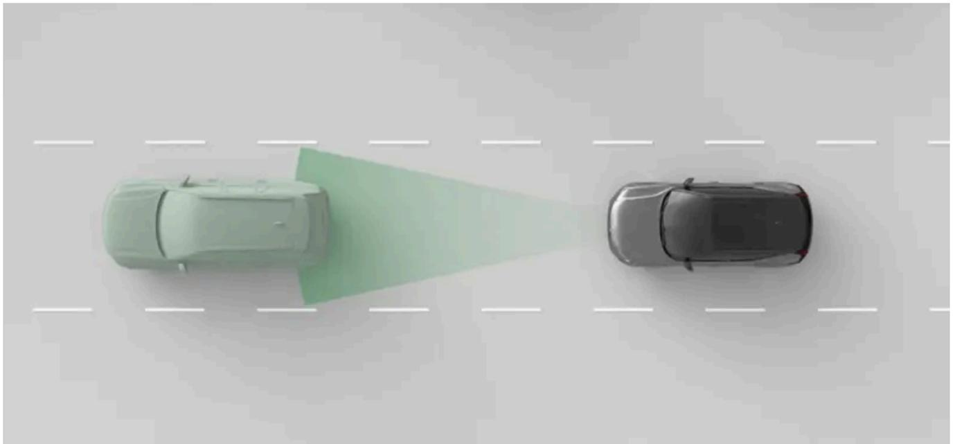
L'Adaptive Cruise Control<sup>[1]</sup> può aiutarti a mantenere una velocità prestabilita. Quando guidi con l'Adaptive Cruise Control attivo, seleziona una velocità di riferimento. L'auto gestisce l'accelerazione e la frenata per raggiungere la velocità impostata, adattandosi al traffico circostante.
