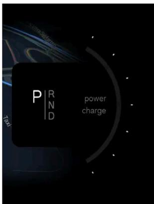
La modalità di guida selezionata viene visualizzata sul display del conducente sopra la marcia selezionata.
