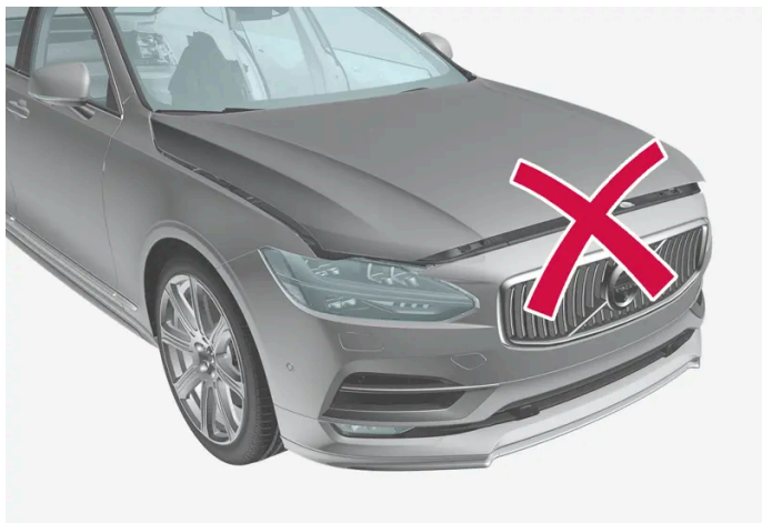
Cofano non completamente chiuso.
