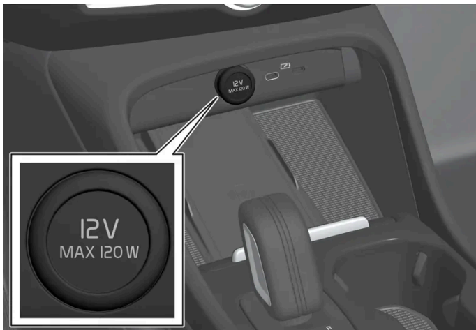
Presenza elettrica da 12 V nel tunnel, sedile anteriore.
