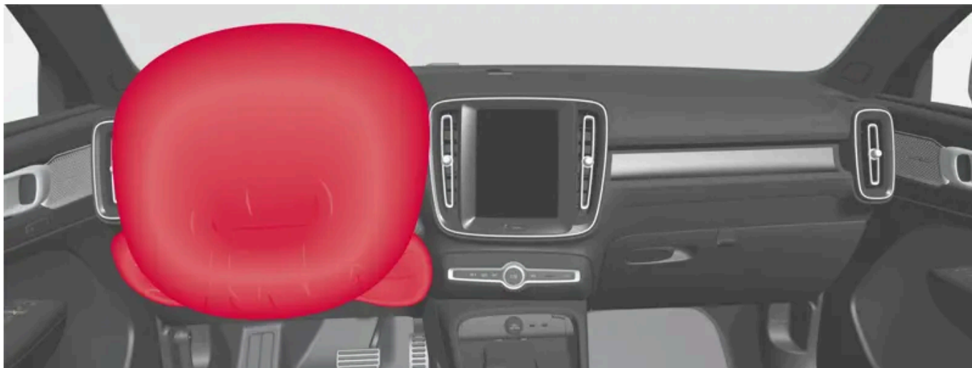
Airbag nel volante e airbag ginocchia [1] nel sedile anteriore sul lato conducente.
