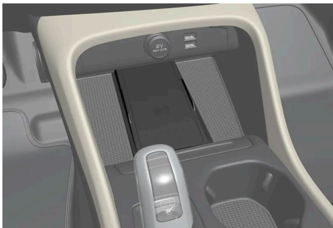
Caricabatterie senza fili per telefono davanti alla leva selettore
