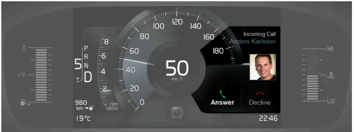
Esempio di messaggio sul display del conducente da 8 pollici. La figura è schematica - i dettagli possono differire a seconda del modello di automobile.
