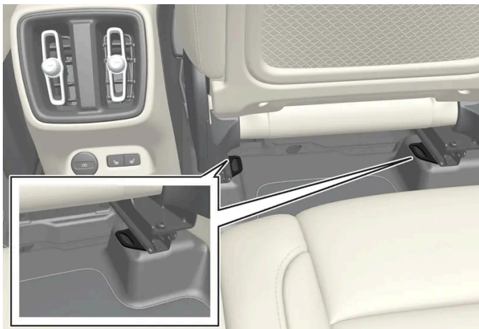
Posizione dei punti di fissaggio nel sedile posteriore.
