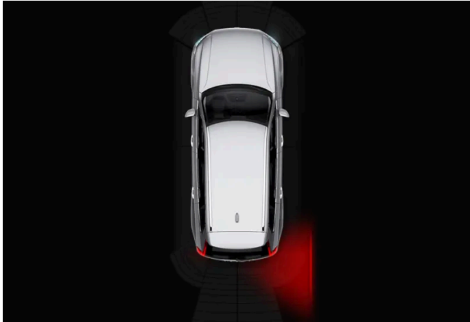
Icona Cross Traffic Alert accesa nella grafica Assistenza al parcheggio dello schermo.
