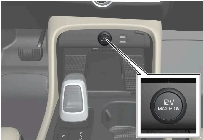
Presse elettriche da 12 V nel tunnel, sedile anteriore.
