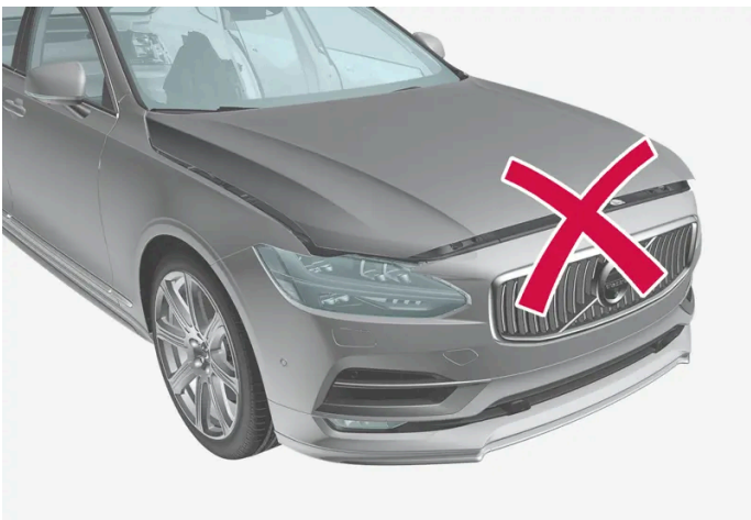
Cofano non completamente chiuso.
