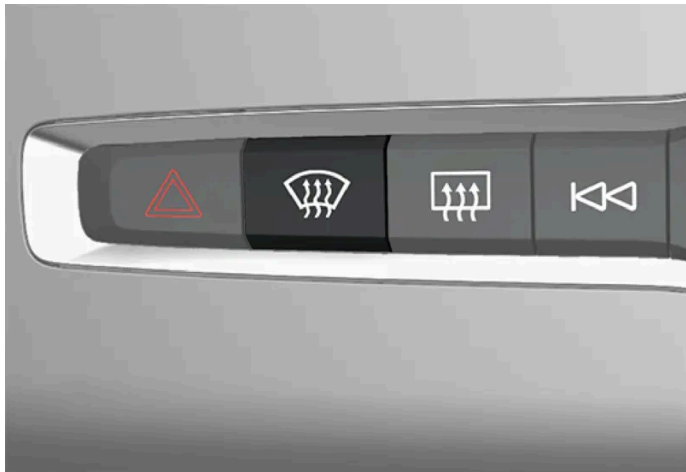
Pulsante fisico nel quadro centrale.
