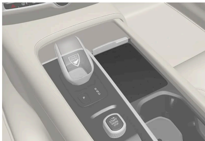
Caricatore wireless nel tunnel.
