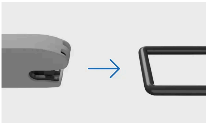
Fissare l'attacco ISOFIX nel punto di fissaggio
