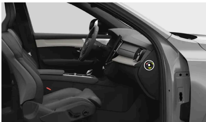
Posizione dell'interruttore dell'airbag passeggero
