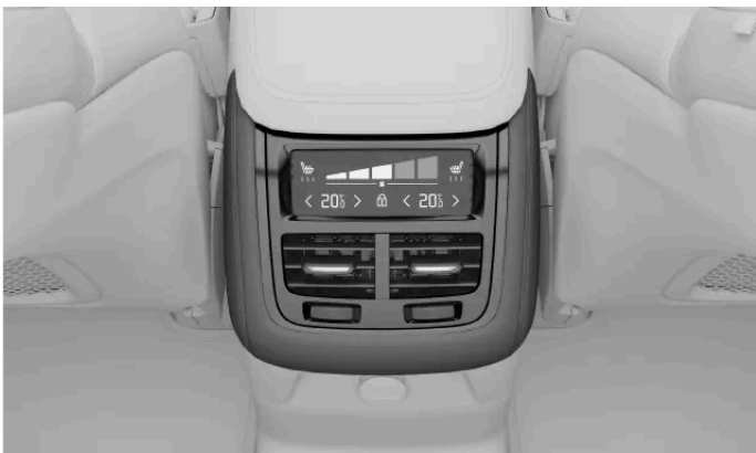
Comandi del climatizzatore nel tunnel centrale
