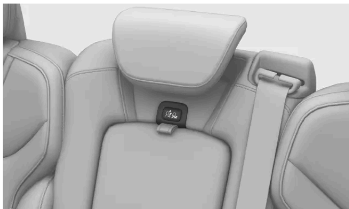
Pulsante di blocco nel poggiatesta centrale
