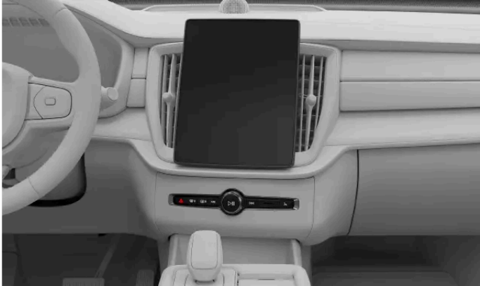
Pulsanti dello sbrinatori sulla plancia di comando sotto il display centrale
