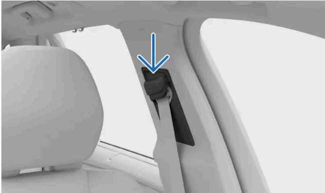
Punto di fissaggio superiore della cintura di sicurezza
