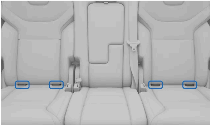
Posizione dei punti di attacco ISOFIX nei sedili della seconda fila
