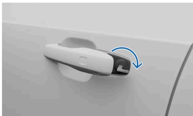
**5** Ruota la chiave di 45 gradi in senso antiorario fino alla posizione iniziale e rimuovila.
