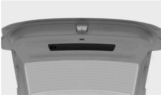
Il triangolo di emergenza si trova all'interno del bagagliaio. Apri il vano ruotando la maniglia in posizione verticale e poi tirala.
