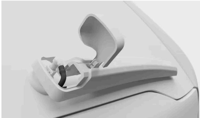
Individua la protezione di plastica nel punto in cui il braccio del tergilavoro è fissato all'auto. Allenta prima il lato della protezione più vicino a te e poi quello più lontano. Solleva completamente la protezione di plastica. In questo modo accedi al connettore del tubo.
