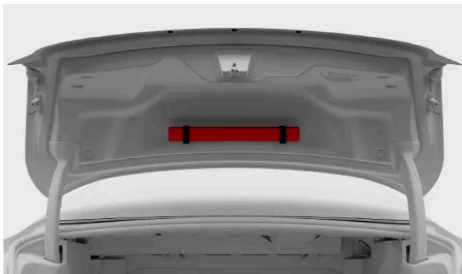
Il triangolo di emergenza si trova all'interno del bagagliaio. Apri il vano ruotando le maniglie in posizione verticale e poi tirale.
