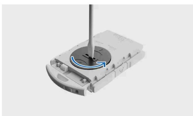
Utilizzando uno strumento adatto, come un cacciavite o una moneta, ruota il coperchio della batteria in senso antiorario per sbloccarlo.
