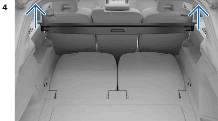
Solleva completamente il pianale dalle rientranze sul retro del bagagliaio per rimuoverlo.
