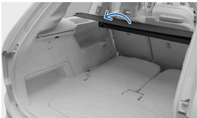
Estrarre la schermata del pianale tramite la maniglia sopra i pannelli laterali del bagagliaio.
