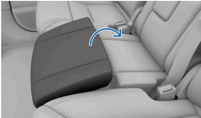
Con una mano sulla parte anteriore del seggiolino per bambini e una sulla parte posteriore, solleva il seggiolino e spingilo all'indietro fino allo schienale del sedile.
