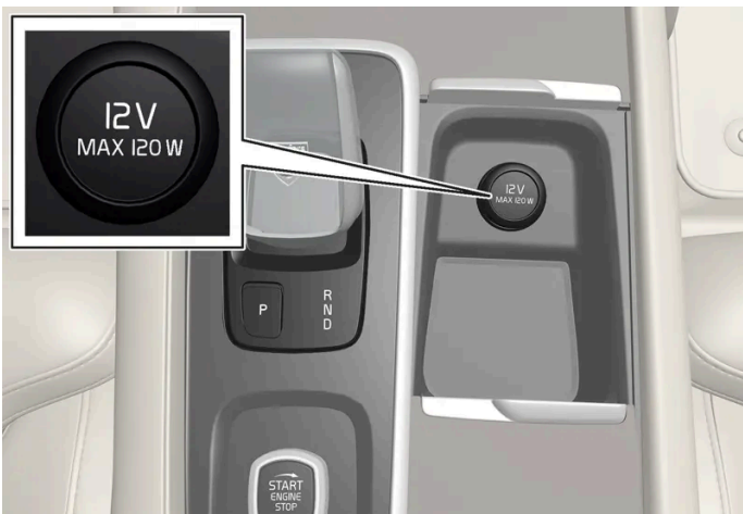
스마트폰 무선 충전기 미장착 차량용 터널 콘솔의 전면 전원 소켓*.
